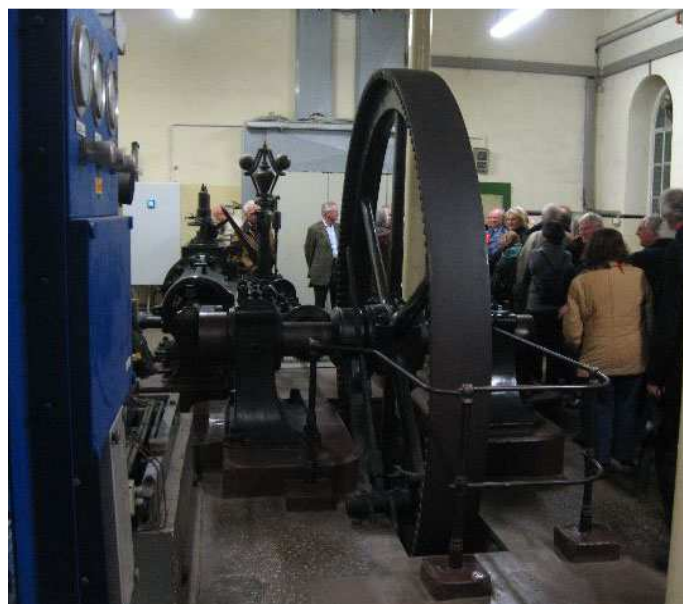
Historische Dampfmaschine zur Kälteproduktion
